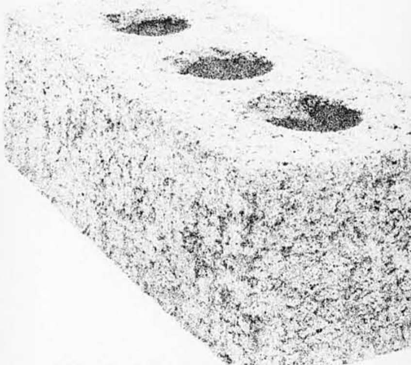
BRIQUE: pierre artificielle à base d'argile moulée mécaniquement sous forme de prisme rectangulaire et cuite au four.
