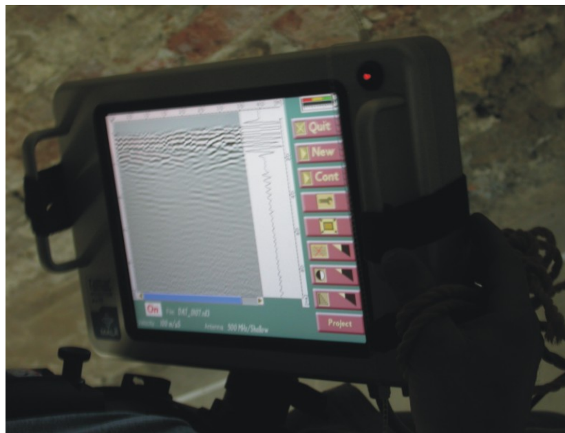
Figure 13. Géoradar RAMAC X3M de la compagnie MALA (Suède) composé d'une antenne blindée de 500 MHz et de son moniteur permettant une visualisation des acquisitions en temps réel.
