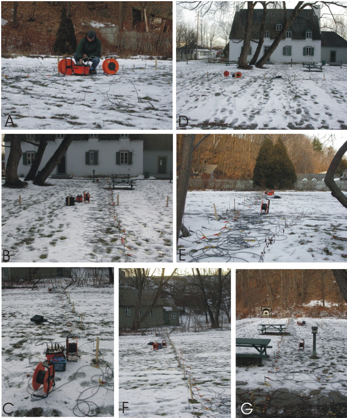
Figure 33. Photographies montrant les dispositifs du levé de résistivité électrique implantés sur le site de la Maison des Jésuites (décembre 2007).
