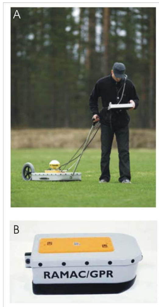
Figure 12. Système Géoradar RAMAC de la compagnie Mala . Le système comporte une antenne blindée, une roue de précision (évaluation des distances) ainsi qu'un moniteur permettant de visualiser les spectres radar en temps réel.
