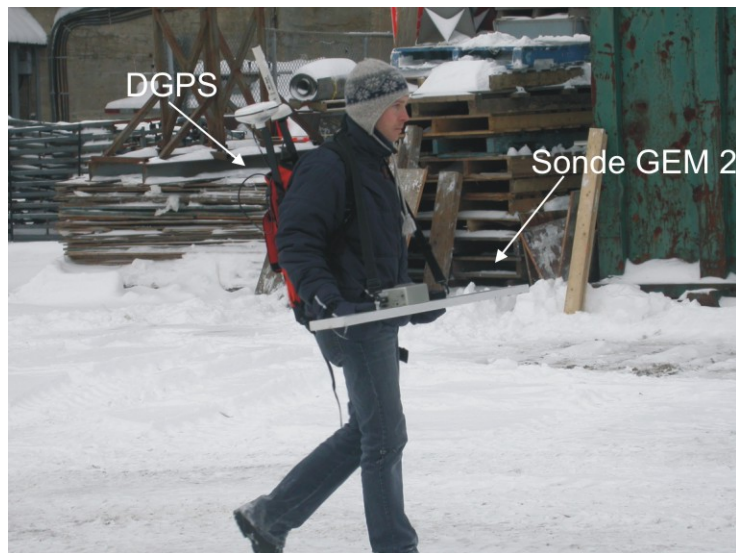
Figure 10. La sonde d'induction électromagnétique GEM-2 multifréquences couplée à un système de positionnement DGPS sub-métrique (photo : quai de la Garde côtière du Canada, Port de Québec).
