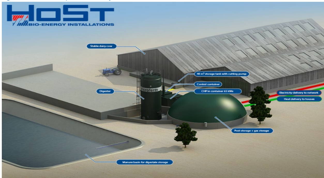
Figure 4 : schéma du procédé Micorferm de Host
