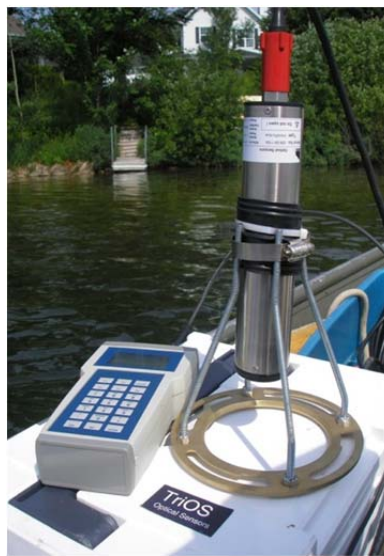
Figure 4.14 Sonde submersible MicroFlu-blue (Trios) et trépied adapté pour des mesures au fond de la colonne d'eau (D. Rolland)
