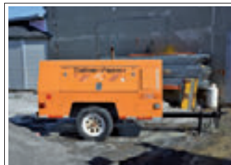
Compresseur à air SULLIVAN modèle D250 Q, moteur diesel John Deere.
