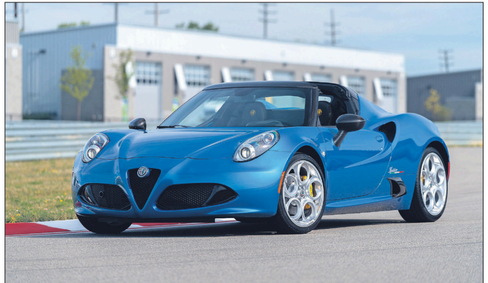
La version Italia de l'Alfa Romeo 4C Spider est mue par un L4 turbo de 1,7 l (237 ch) en position centrale. Ce roadster ne pèse que 1128 kg.
