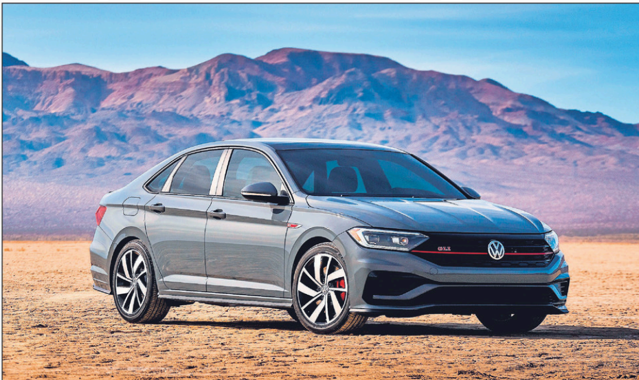
La Volkswagen Jetta GLI 2020 est mue par un L4 turbo de 2,0 l (228 ch). La suspension sport a été abaissée de 1,5 cm par rapport à la Jetta régulière.
