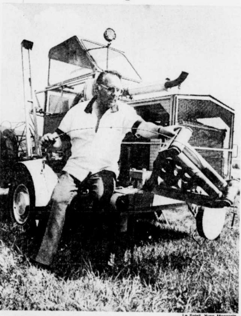
Ronald Doyon devant le treuil qu'il a lui-même fabriqué, un appareil capable de grimper un planeur à 1,000 pieds d'altitude en 15 secondes.
