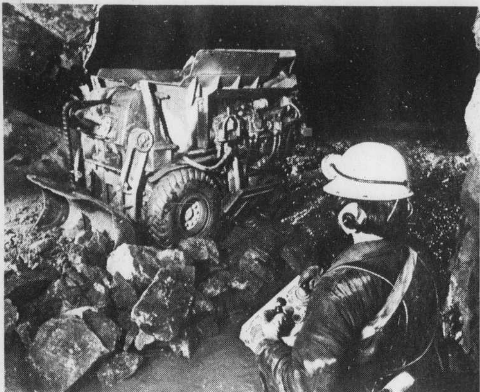
Le développement technologique du monde minier est constant, comme en fait foi cette photo. Voici que la science-fiction gagne le sous-sol. Ce robot minier offre le double avantage de s'engager dans des galeries étroites et de manoeuvrer dans des conditions difficiles.
