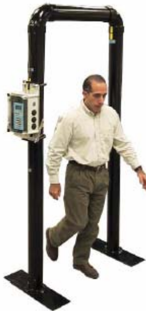
Figure 3 : Portail dosimétrique pour la détection de la contamination radioactive
