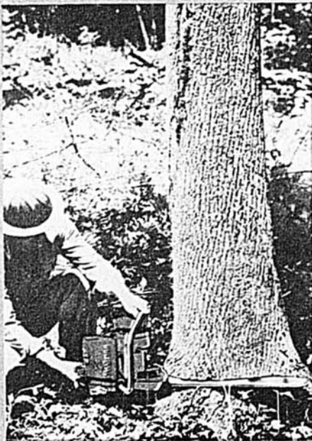
La poignée spéciale vous permet de couper au ras du sol, éliminant ainsi les souches.
