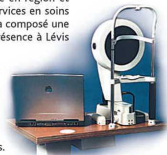
Le Pentacam mesure la courbe et l'épaisseur de la cornée, mesure la profondeur jusqu'au cristallin et offre une multitude d'autres fonctions.
