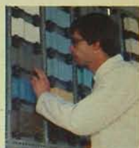
Recherche dynamique : la Stelco effectue des essais d'exposition de longue durée sur l'acier préfini.
