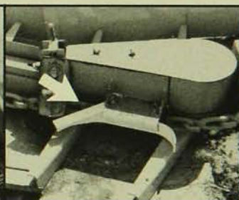
Sabot de retour à raccordement pivotant de nettoyeur de rigole non protégé.
