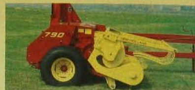
Nouveau ramasseur d'andains à bout ouvert, avec roue de mesure et rouleau, améliore l'efficacité et capacité de récolte.
