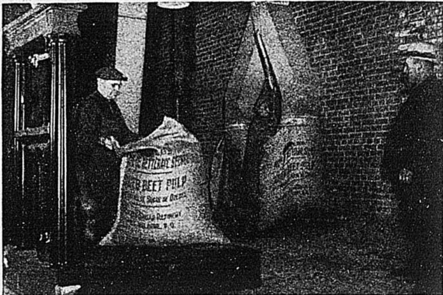
C'est ici que se fait l'empochage de la pulpe. Lorsque le sac est plein l'ouvrier le pèse et le coud. La pulpe de betterave se vend au prix de $30.00 la tonne.
