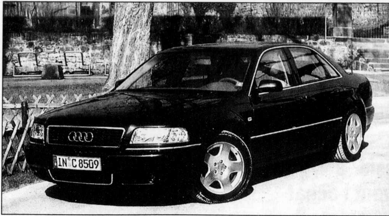
Le châssis et la carrosserie de la Audi A8 sont entièrement réalisés en aluminium.
