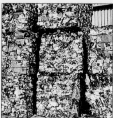
La presse sert à fabriquer des ballots avec les matières recyclables.
