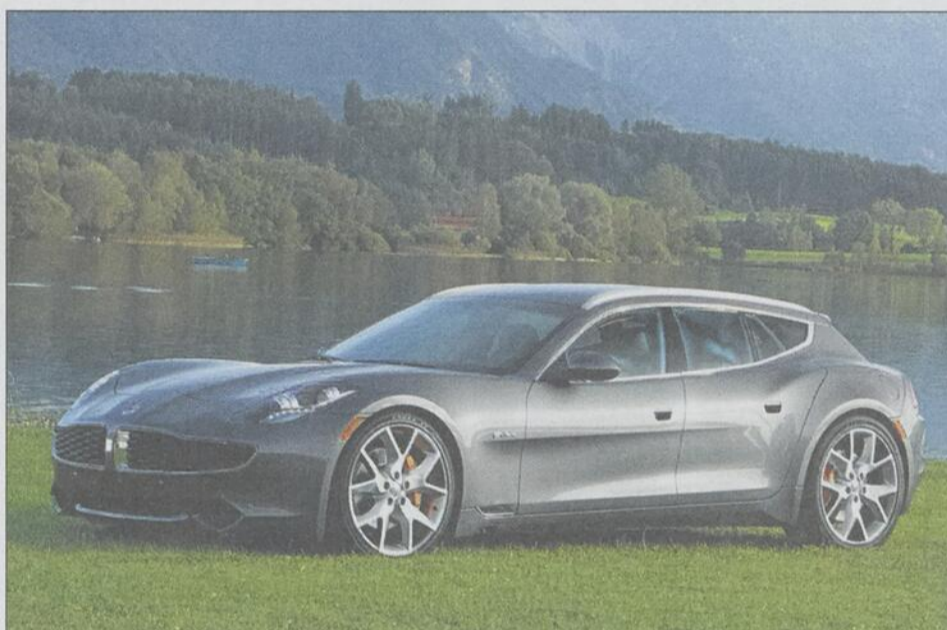
Le constructeur californien Fisker a présenté la Surf 2013 qui est une voiture propulsée par deux moteurs électriques de 403 chevaux. On retrouve également un moteur thermique qui sert de générateur d'électricité pour les batteries au lithium-ion.
