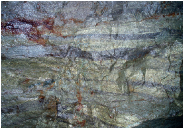
PHOTO 7.3 - Minéralisation rubanée de sulfures massifs volcanogènes (nAw7; chalcopyrite et sphalérite) exposée sous terre à la mine Persévérance, Zone Principale. Groupe de Lac Watson, Flanc Sud, Feuillet 32F13.
