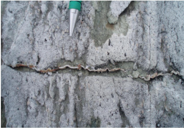
PHOTO 4.1 - Minces veinules de quartz avec fronts d'altération intense en chlorite, recoupant une rhyolite massive porphyrique à phénocristaux de quartz (nAw11). Groupe de Lac Watson, Flanc Sud. Affleurement 2011-PP-40, feuillet 32F12.
