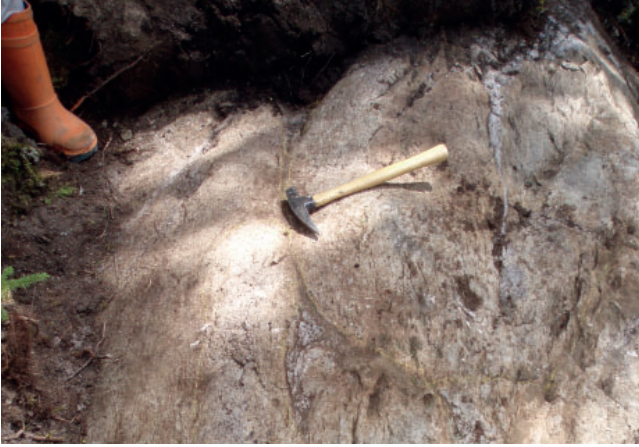
PHOTO 13.1 - Andésite coussinée fortement amygdalaire, Formation de Daniel (nAdnl), Plaine Centrale. Rive est du lac MacIvor. Affleurement 2011-PP-57, feuillet 32F13.
