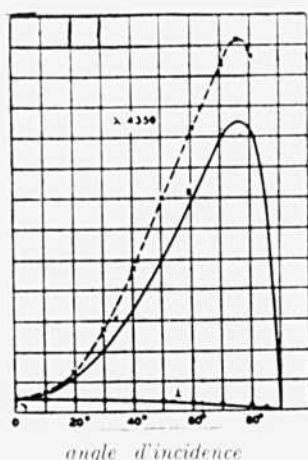
Fig. 9A—Intensité électrique immédiatement au-dessus de la surface du platine (courbe en trait plein) et courants photoélectriques obtenus avec un film mince de potassium sur platine (cercles et croix). Lumière bleue.
