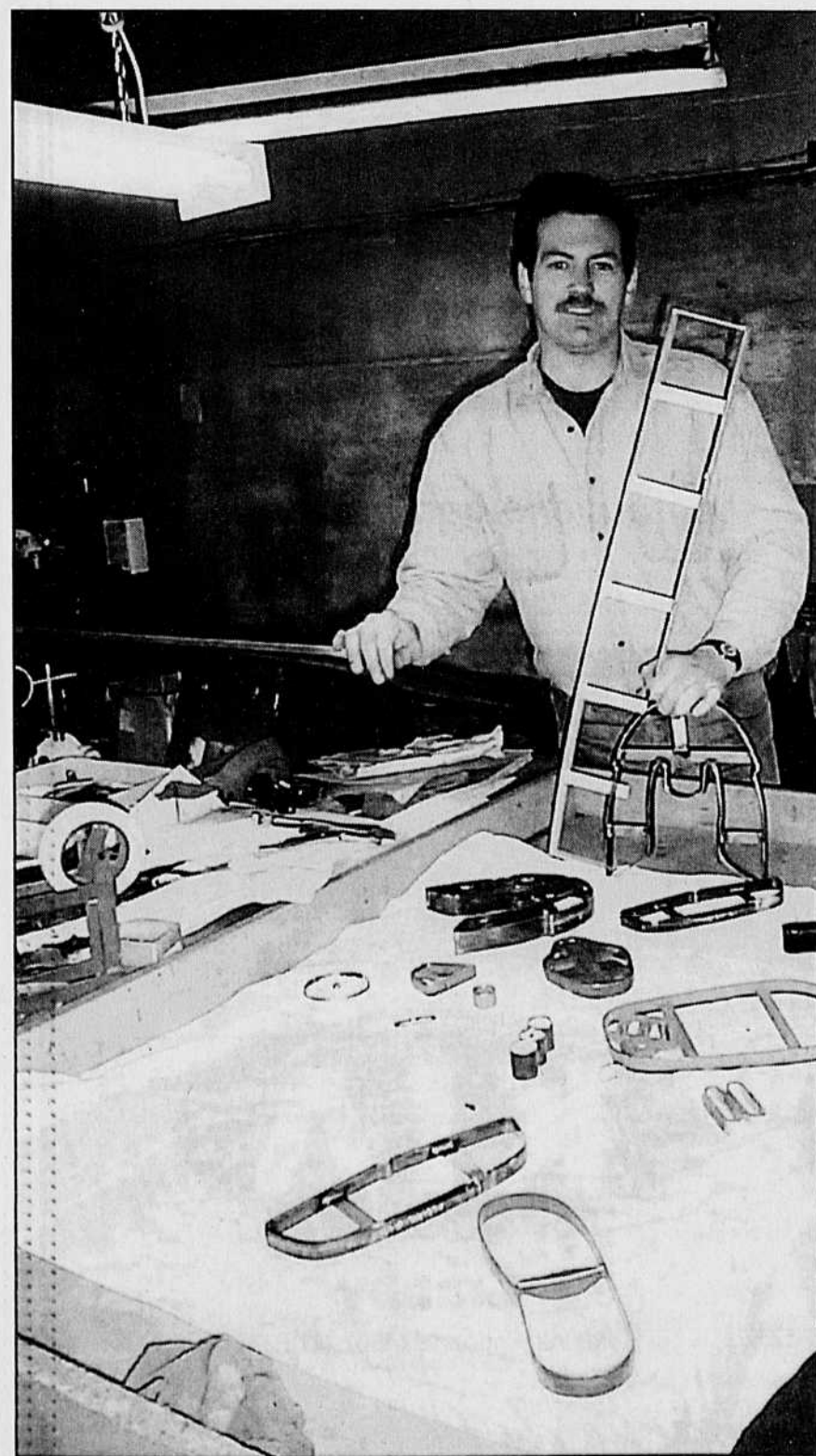
Photo La Tribune, Guy Marchand Yvan Gagné est le propriétaire de l'entreprise Les emporte-pièces, située à Richmond. Il conçoit et fabrique des emporte-pièces sur devis que l'on peut voir sur cette table, lesquels servent à couper différents matériaux tels le tissu, le cuir, le plastique, le caoutchouc et autres.
