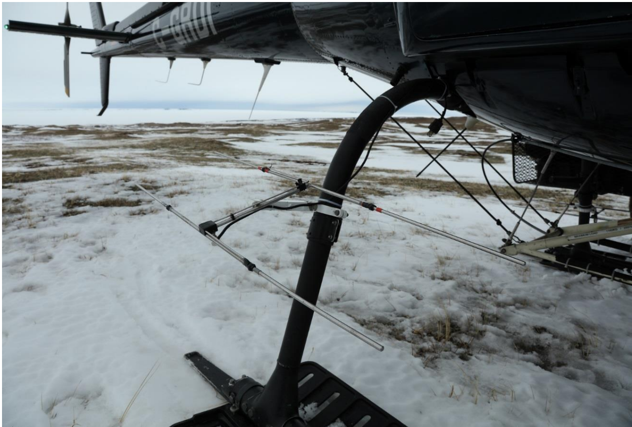
Figure 3. Exemple d'une des trois antennes directionnelles de type « H » qui sont fixées aux patins de l'hélicoptère grâce à une attache homologuée par Transport Canada et reliées au système de télémétrie VHF par un câble coaxial.
