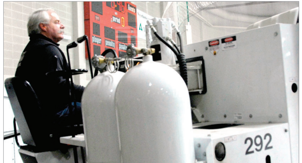
Les surfaceuses ayant un moteur à combustion sont les principales sources d'émission de monoxyde de carbone dans les arénas.
