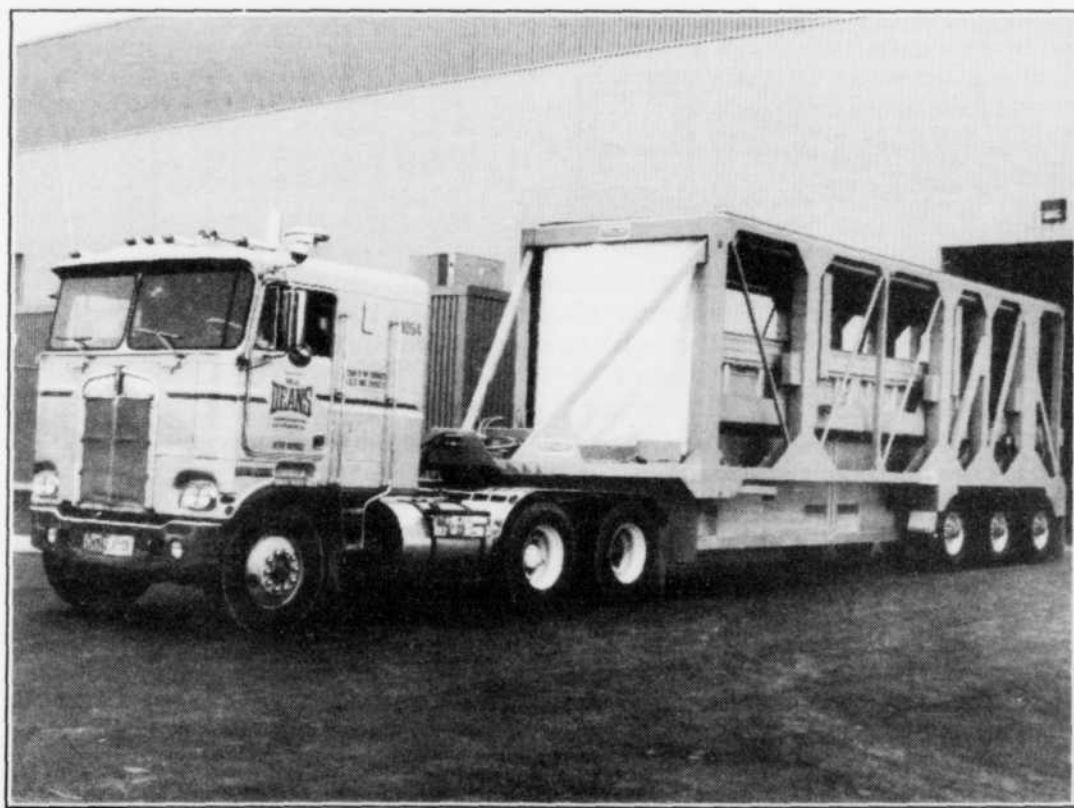
On voit sur ce cliché le camion d'allure étrange qui recueillera les boîtes d'écume d'aluminium dans les centres de coulée, pour les transporter jusqu'à l'Usine Guillaume-Tremblay.
