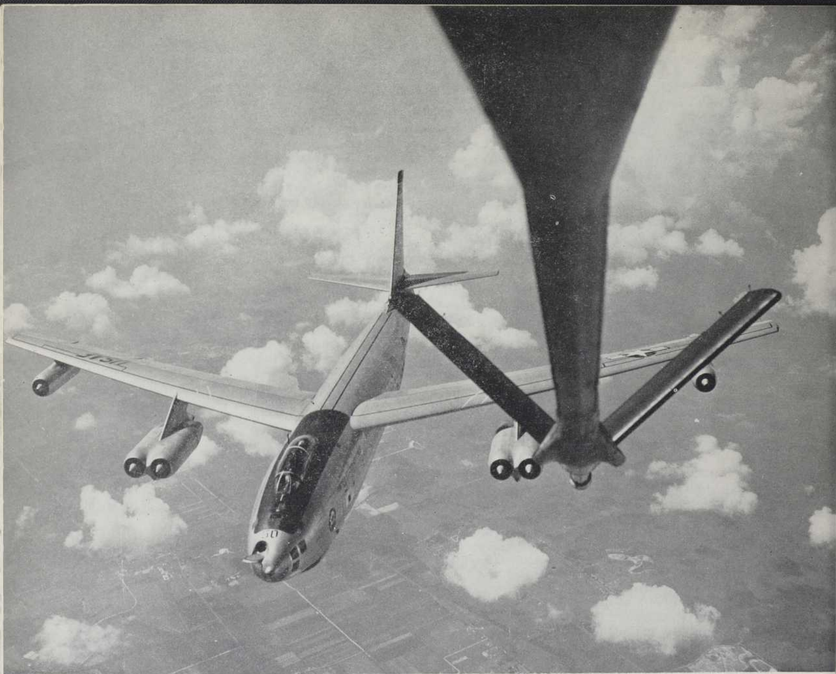
Munie de deux ailerons, à droite, l'extrémité du targon pend dans le vent sous l'avion-citerne, cherchant l'ouverture dans le nez du bombardier pour y verser sa provision d'essence.
