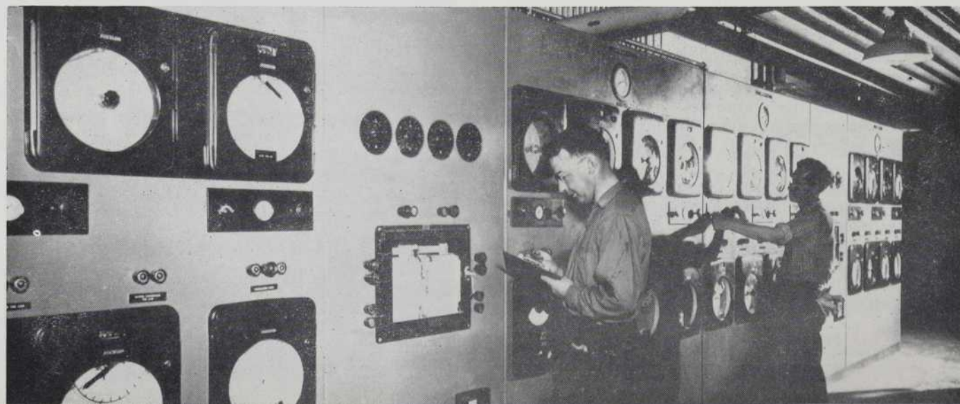
Un des nombreux panneaux de contrôle de l'usine de « Terylène ». Ici, des opérateurs vérifient, à intervalles réguliers, les instruments de l'étage de la polymérisation.
