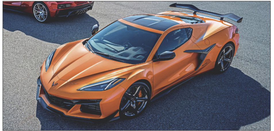
La Chevrolet Corvette Z06 est propulsée par un tout nouveau V8 atmosphérique de 5,5 litres qui produit 670 chevaux à 8600 tr/min.
