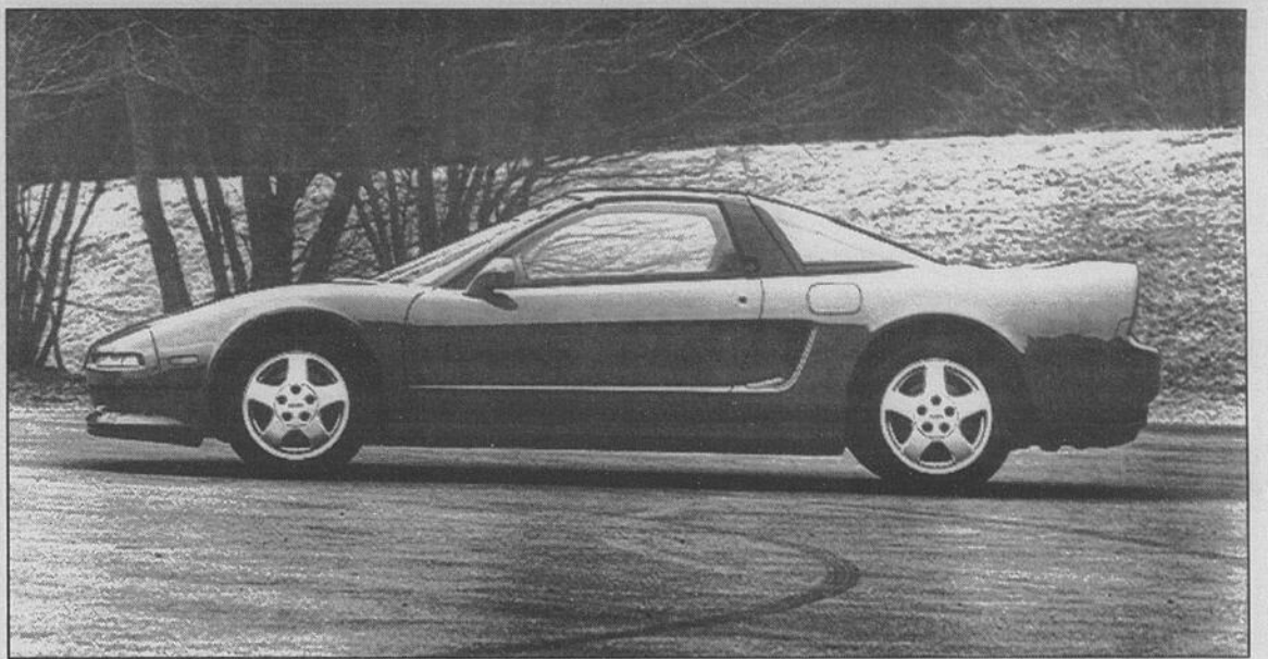
Le coupé sport NS-X possède un moteur V-6 central arrière de 3 litres à 24 soupapes de 270 chevaux. En plus de posséder une ligne racée, elle se démarque par sa caisse et sa suspension en aluminium ainsi que par son système de contrôle de la traction arrière. Selon le constructeur, la NX-X peut accélérer de 0 à 100 km en 5,4 sec. et atteindre 270 kmh.
