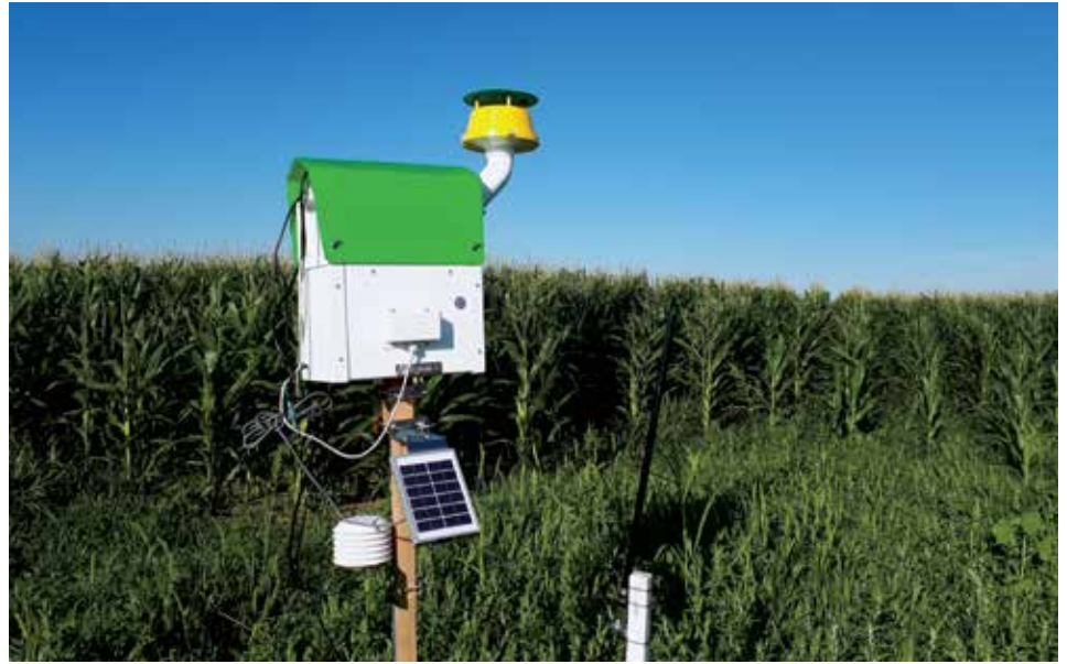
Piège automatisé Trapview utilisé pour le dépistage des papillons par Julien Saguez
