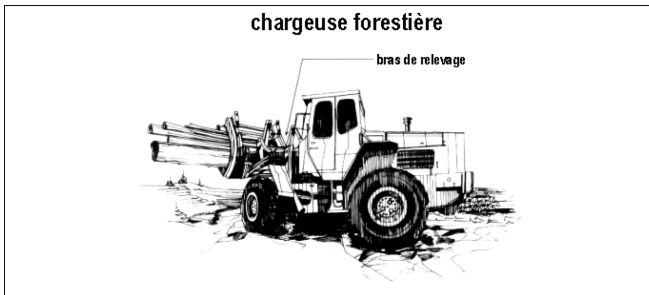
Figure III.11 Illustration d'une chargeuse forestière
