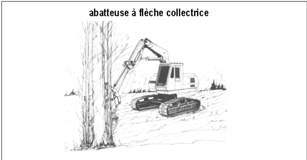
Figure III.2 Illustration d'une abatteuse à flèche collectrice
