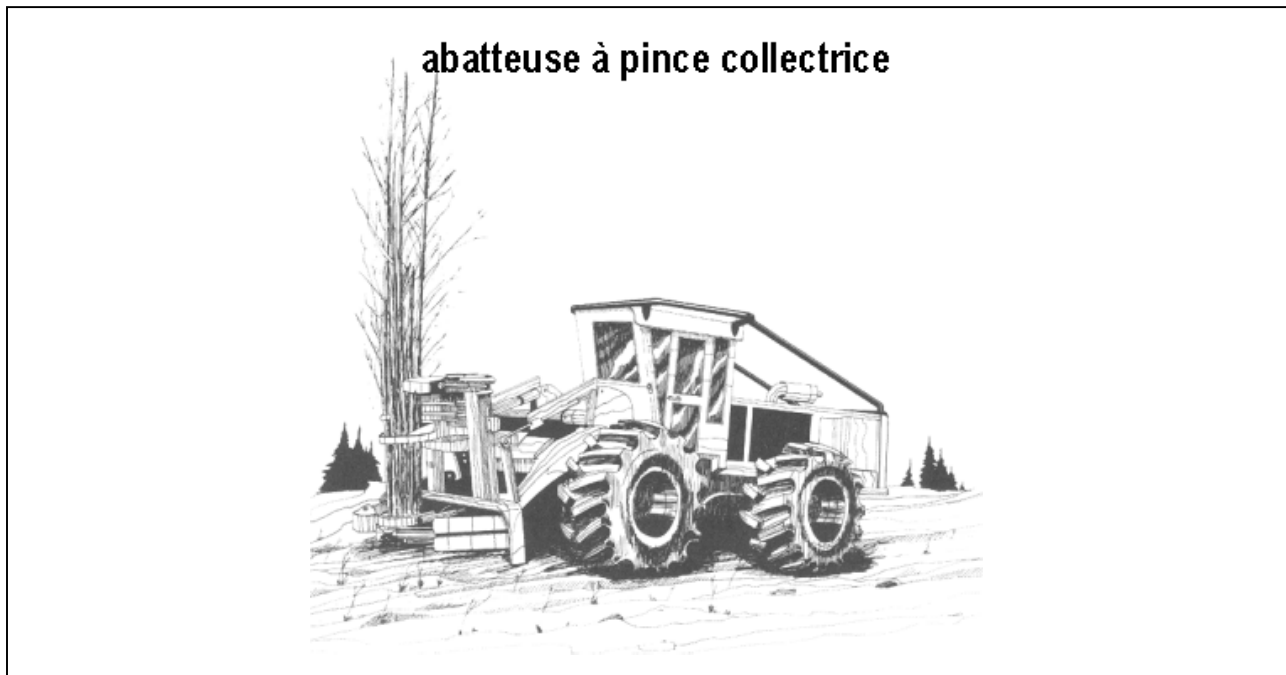
Figure III.3 Illustration d'une abatteuse à pince collectrice
