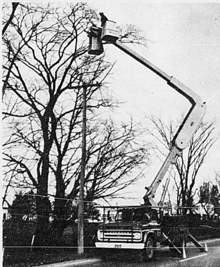
Voici la nacelle aérienne montée sur camion, acquise dernièrement par le service de Production. L'appareil peut s'élever jusqu'à 55 pieds du sol et sert principalement à l'émondage des arbres, mais ses usages sont multiples. Trois unités identiques ont été commandées pour les divisions de Hull, Lachute et St-Jérôme.
