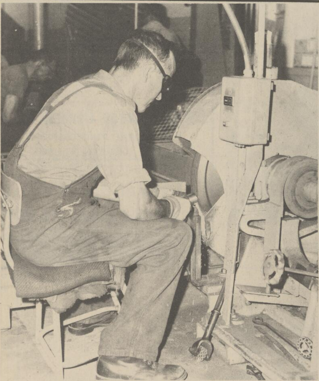
Claude Delorme, un employé de plus de 30 ans de service, polit les têtes de marteaux avant l'assemblage final.
