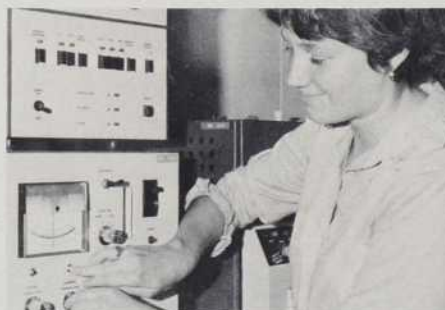
Utilisation de la technique d'absorption atomique, pour faire des mesures de concentration des métaux à l'état de trace dans l'eau de mer.
