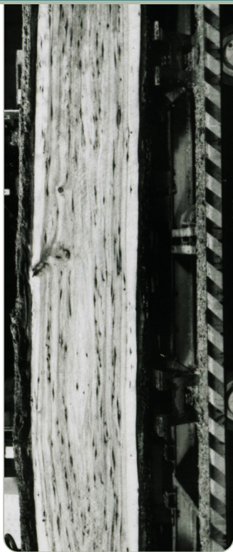
Figure 60 — Coupe révélant l'impact des piqûres
