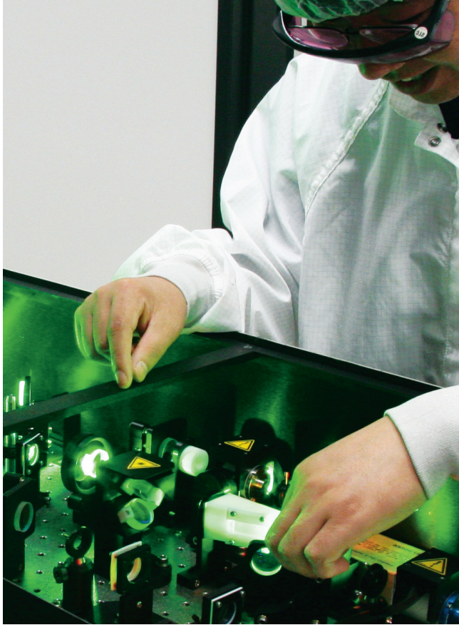
Stagiaire postdoctoral dans le laboratoire de la science du laser ultrarapide et intense en train de faire une mise au point à un laser femtoseconde utilisé dans des expériences de détection de polluants atmosphériques. Le chercheur responsable est le professeur See Leang Chin de l'Université Laval.
