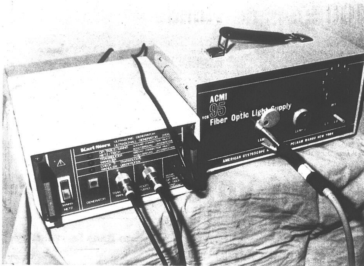
De ces deux petites boîtes sortent les ultrasons et la lumière qui font fendre les pierres aux reins.
