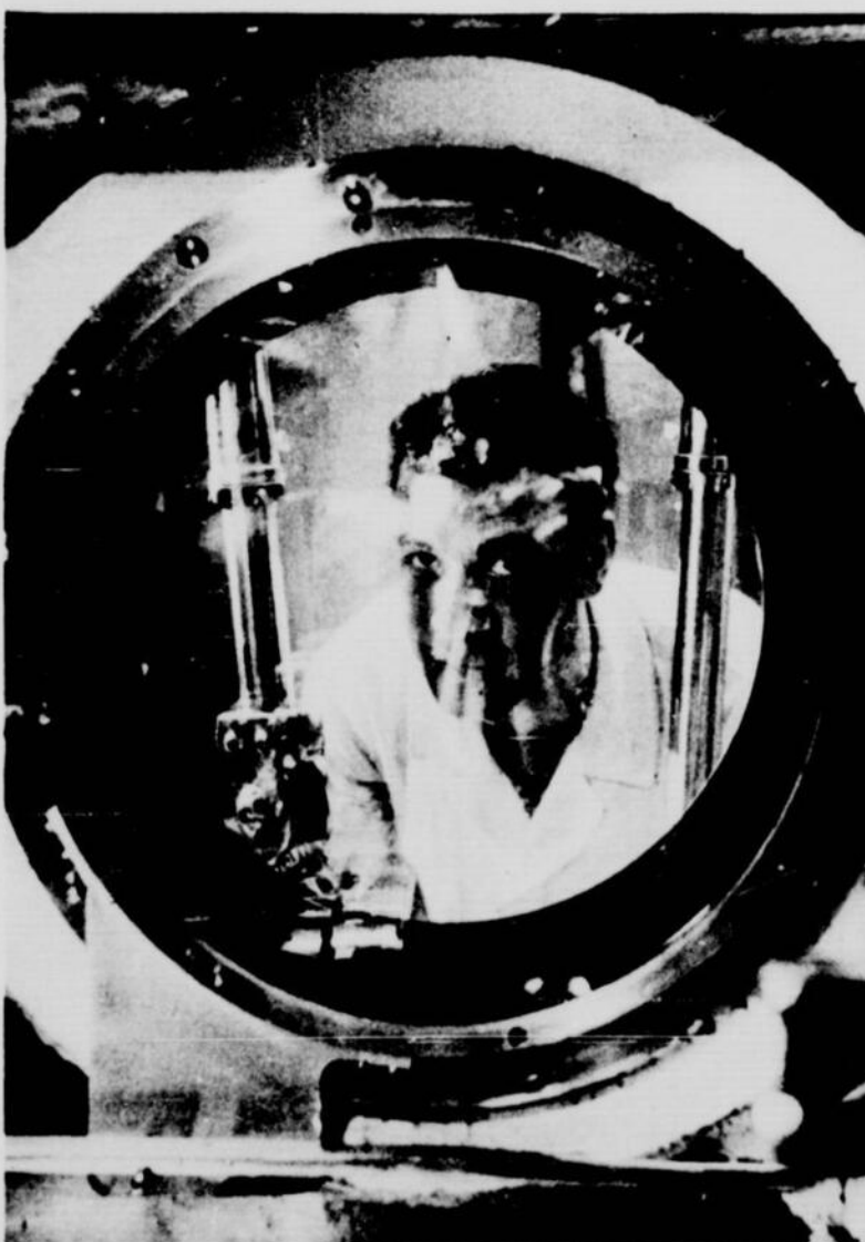
Un technicien jette un coup d'oeil sur les chambres de combustion où les matériaux radioactifs sont manipulés au moyen de bras mécaniques, actionnés au moyen de perches mobiles qu'on aperçoit de chaque côté de la tête de l'opérateur. Pour protéger celui-ci contre tout danger de radioactivité, le verre du hublot, plombé, a une épaisseur de près de trois pieds.
