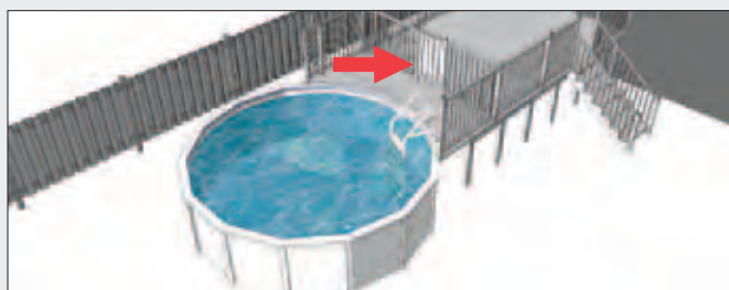
Terrasse aménagée de telle façon que sa partie ouvrant sur la piscine est protégée par une enceinte.
