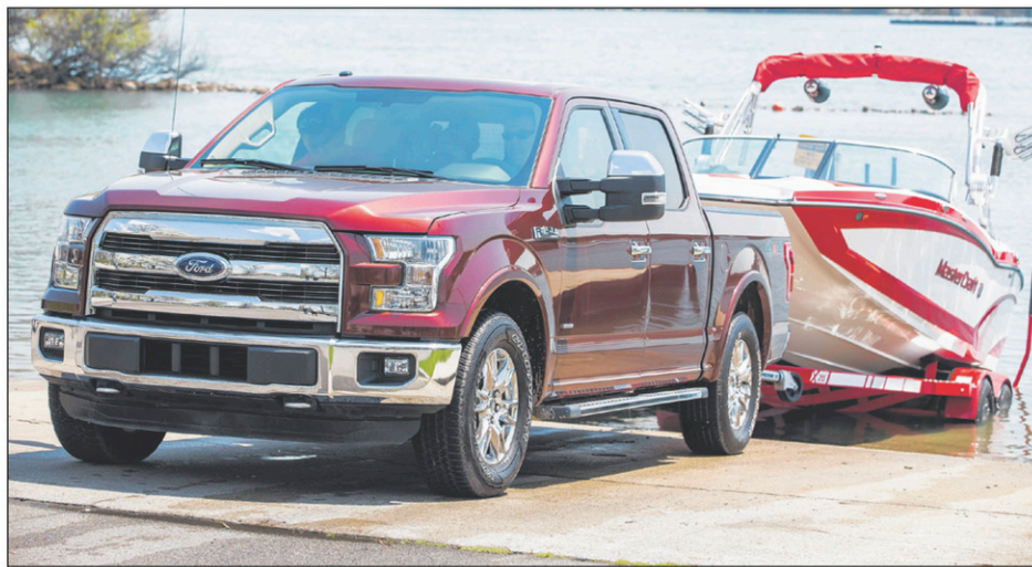
Si le poids de la remorque dépasse 1300 kg (2860 lb), celle-ci doit obligatoirement être équipée d'un système de freinage indépendant.
