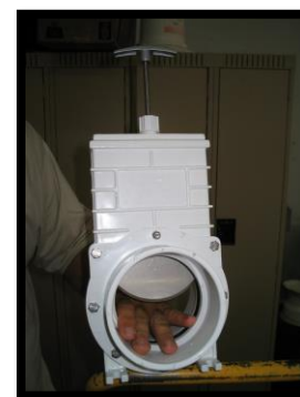
Figure 2.4 Valve permettant l'évacuation du contenu d'un bassin de rétention
