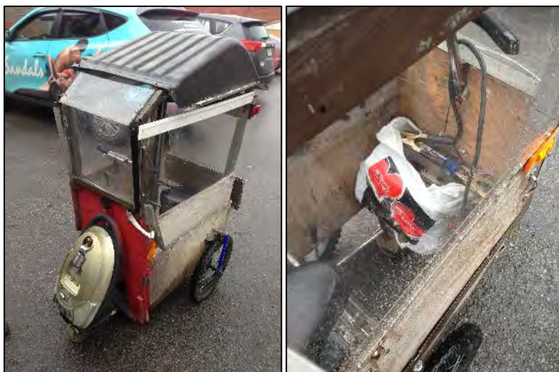
Figure 7 Aspirateur comme moteur, structure de bois et pelle comme toit
