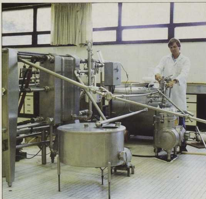
Acheminé à l'usine en camion réfrigéré, le lait est d'abord écrémé à l'aide d'une centrifugeuse (ici le modèle expérimental du STELA). La crème recueillie servira à la fabrication du beurre.
