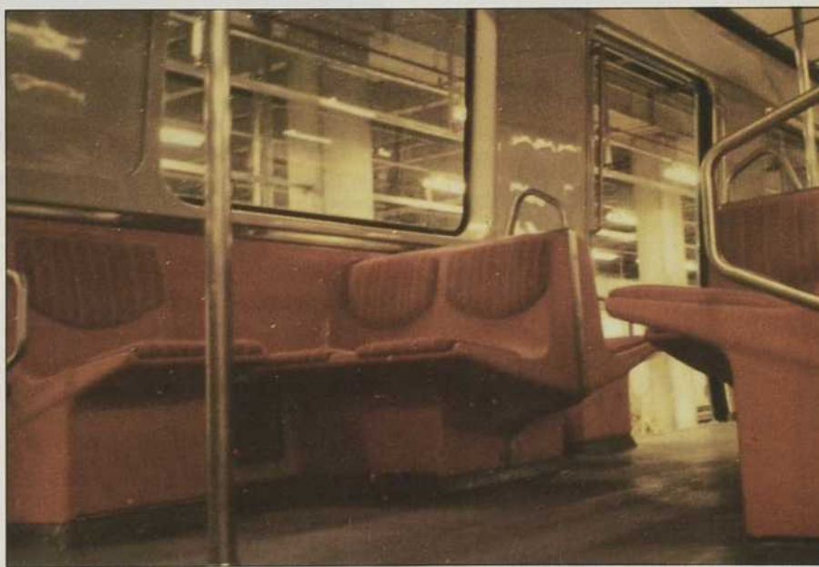
Construits en matériaux composites, les sièges et les panneaux muraux du métro de Montréal ont démontré une résistance au feu inégalée.
