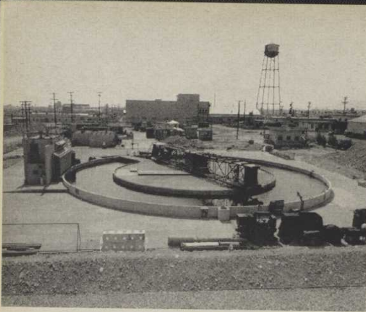
CE BASSIN CIRCULAIRE DE 110 PIEDS DE DIAMETRE ET DE 11 PIEDS DE PROFONDEUR SERT AUX ESSAIS DES DIFFERENTS MODELES DE COQUES. CHAQUE MODELE EST ATTACHE A L'EXTREMITE D'UN MAT PIVOTANT, CAPABLE DE SIMULER UNE VITESSE DE 100 NOEUDS.
