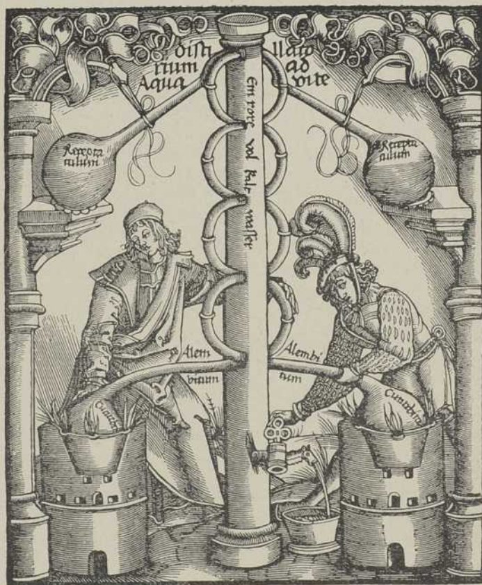
APPAREIL A DISTILLER AVEC SERPENTINS D'APRES UNE GRAVURE SUR BOIS DU XVI e S.
