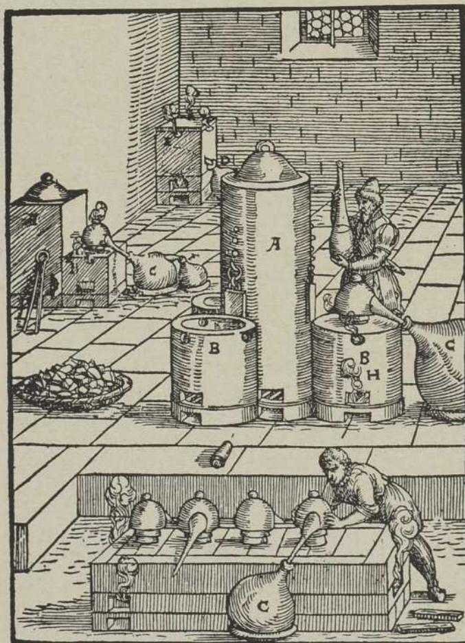
PREPARATION PAR DISTILLATION DE L'ACIDE NITRIQUE D'APRES UNE GRAVURE DE 1698.
