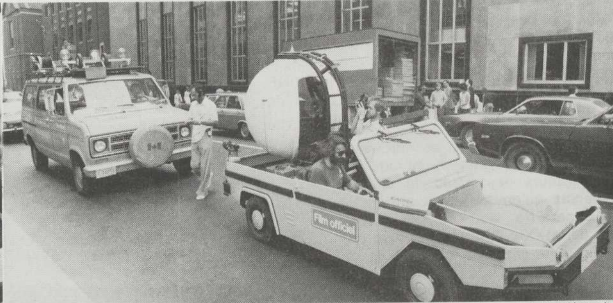
Le système Wesscam: à gauche, la console de contrôle; à droite, la sphère qui contient la caméra. Elle se trouve à l'arrière du véhicule, la console à l'avant.
