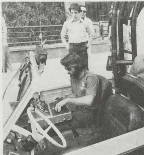
Le système Wesscam: à gauche, la console de contrôle; à droite, la sphère qui contient la caméra. Elle se trouve à l'arrière du véhicule, la console à l'avant.
