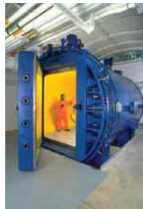
Dans cette chambre d'explosion, on peut faire sauter jusqu'à 5 kg d'explosifs.
