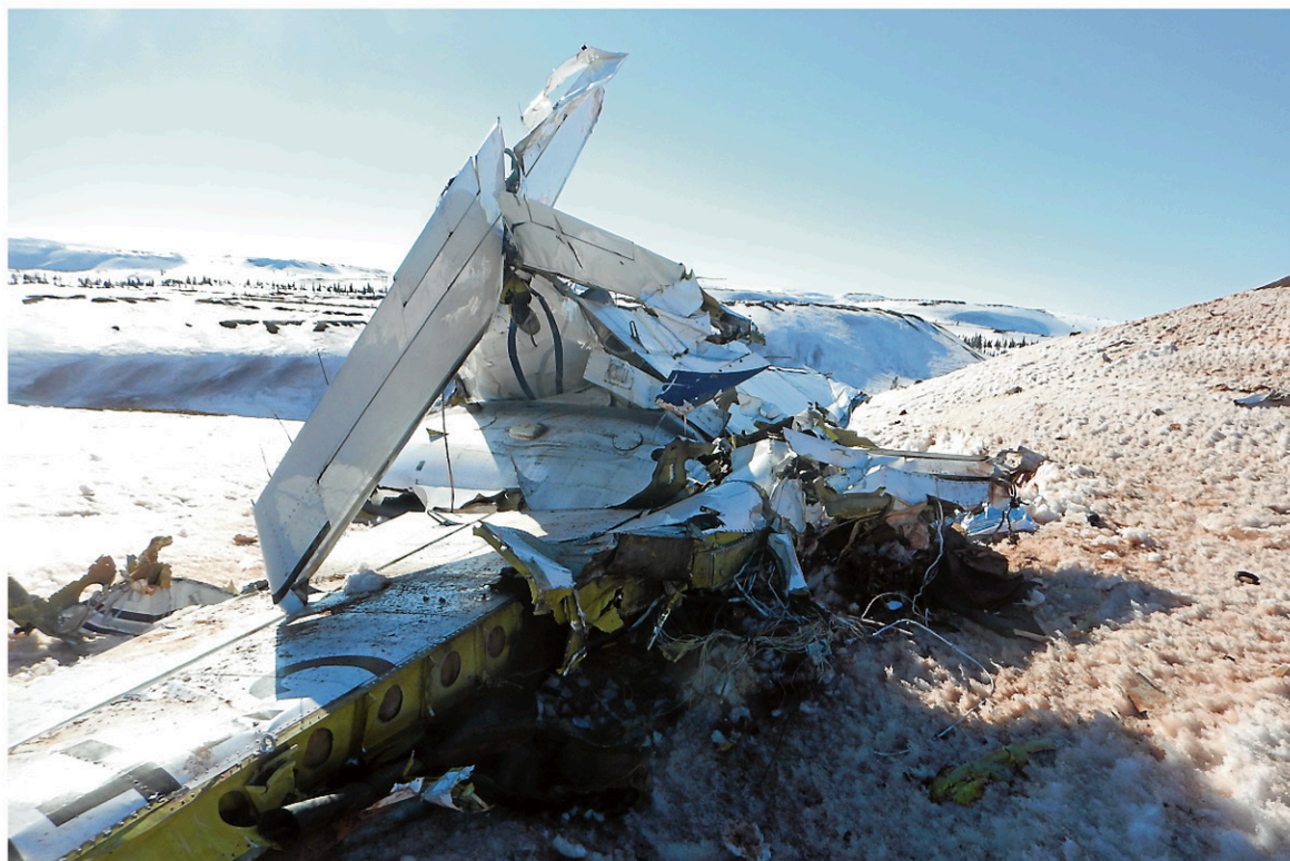
L'épave du Piper Navajo est pratiquement méconnaissable. Ici, on reconnaît l'empennage et un bout d'aile dont le bord d'attaque a été arraché. Les deux pilotes n'ont eu aucune chance, si on se fie à la violence de l'impact. — COURTOISIE BST
