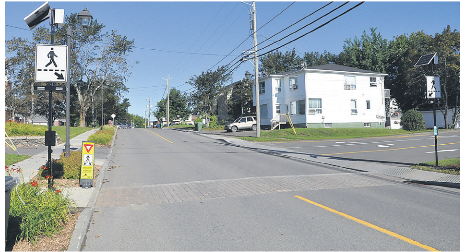
Les signaux rectangulaires à pulsations rapides, semblables aux gyrophares qui équipent les véhicules d'urgence, sont actionnés par un bouton-poussoir et sont alimentés par énergie solaire. (Photo TC Media – Frédéric Durand)
