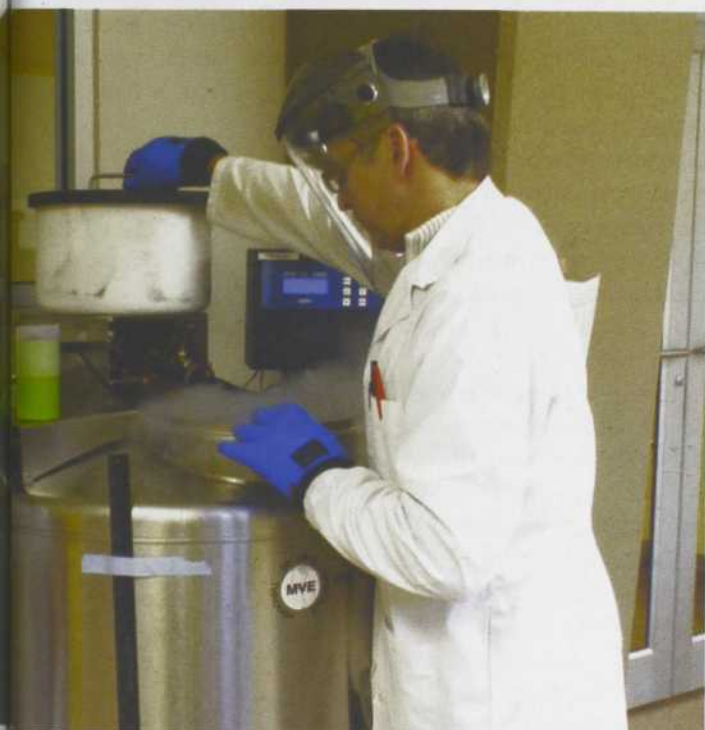
Les échantillons plus sensibles de la biobanque sont conservés dans l'azote liquide à -190^{\circ}\text{C} .
