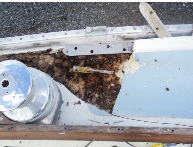
État du balsa dans un pont pourri.
