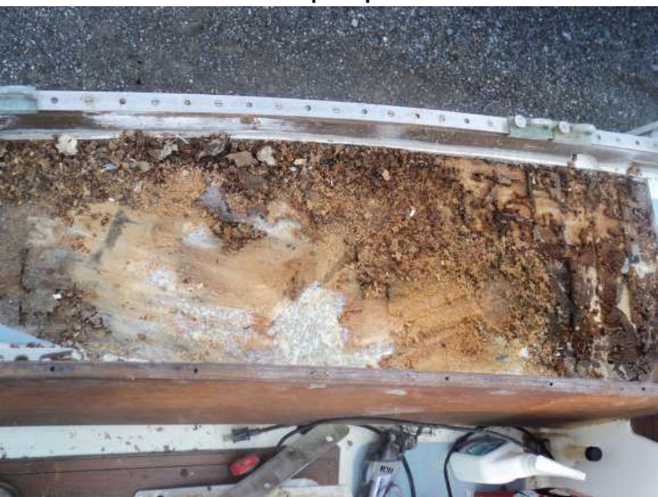
État du balsa dans un pont pourri.
