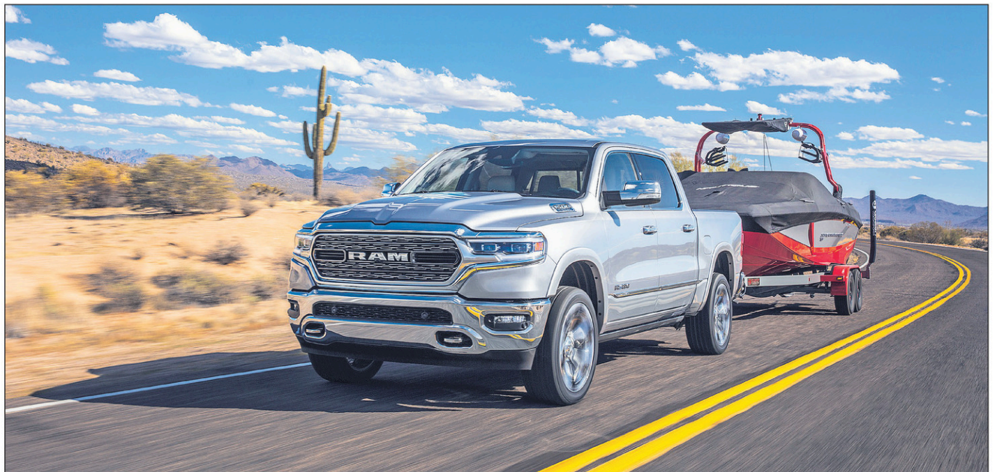
Si le poids de la remorque dépasse 1300 kg (2860 lb), celle-ci doit obligatoirement être équipée d'un système de freinage indépendant.
