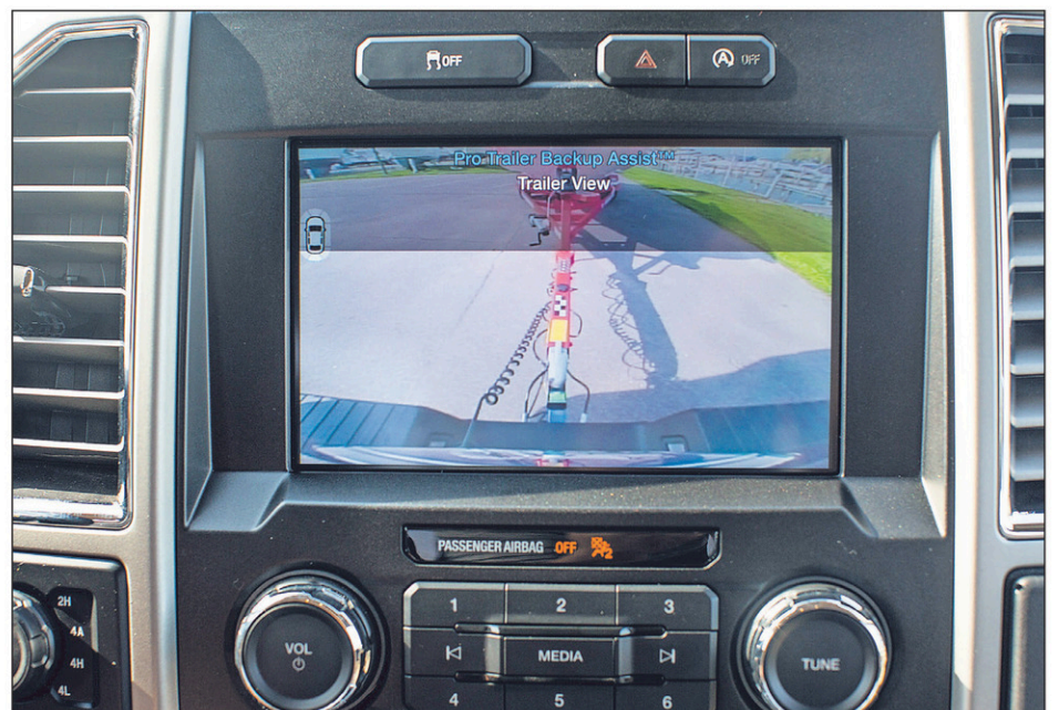
Certaines camionnettes sont équipées d'une caméra de recul avec assistance qui affiche sur l'écran du tableau de bord une ligne de guidage vers l'attelage de la remorque.
