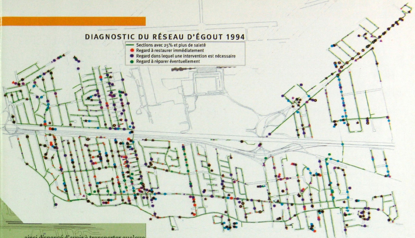
Diagnostic du réseau d'égout, 1994, de la Ville de Dorval par caméra à téléobjectif
