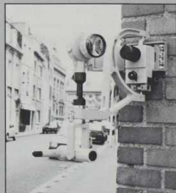
Un repère topométrique mural pour les réseaux enterrés.
