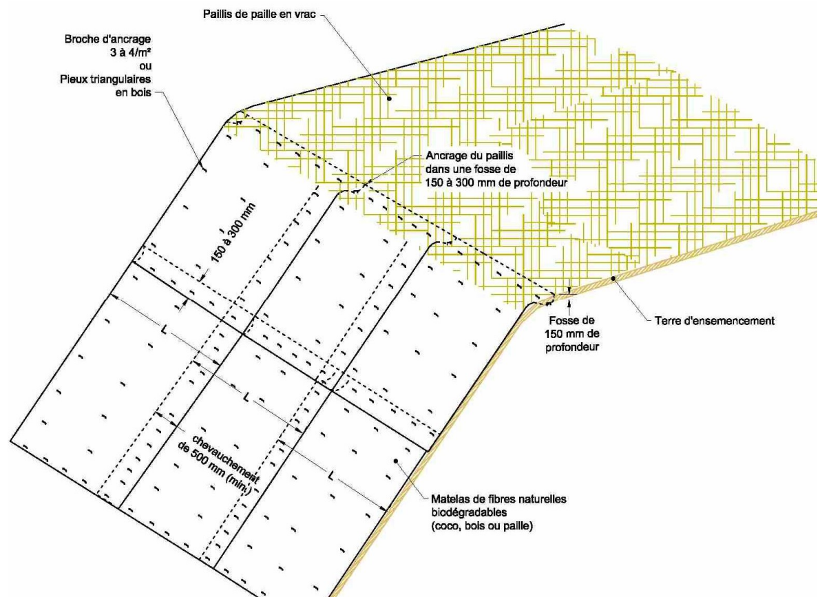
Figure 12 Mise en place des matelas de pailis
